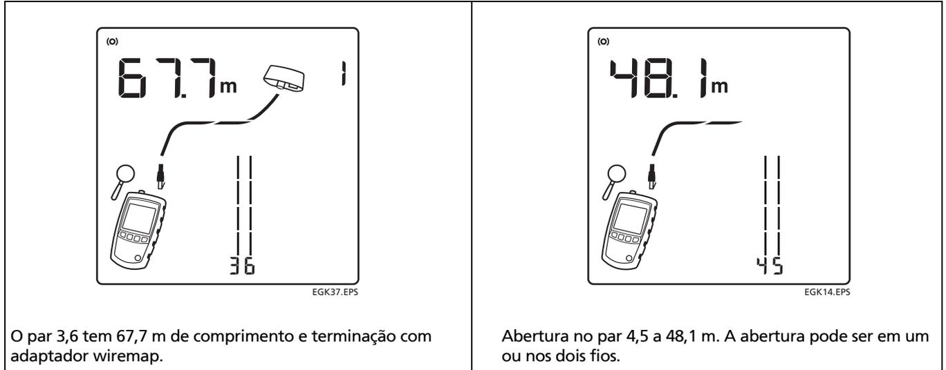
Figura 18. Detalhes para pares de fios de terminação e abertos
